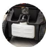
Serbatoio detergente integrato per aspirazione diretta
